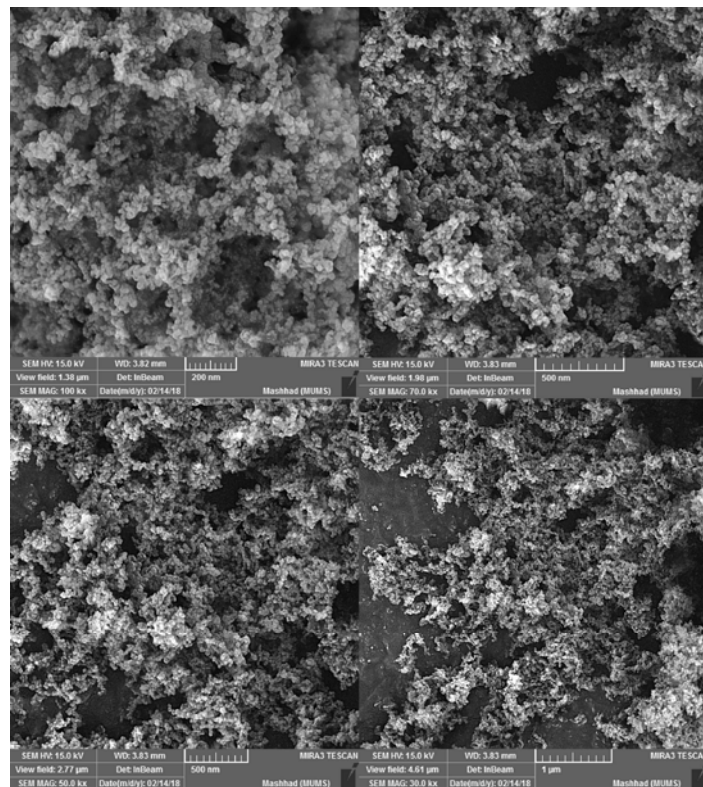
Fig. 4. SEM images of NiFe 2 O 4 @TiO 2 /Pt nanocomposite
