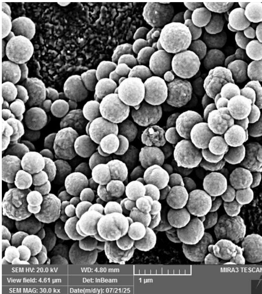
Fig. 1. SEM images of TiO 2 nanoparticles.
