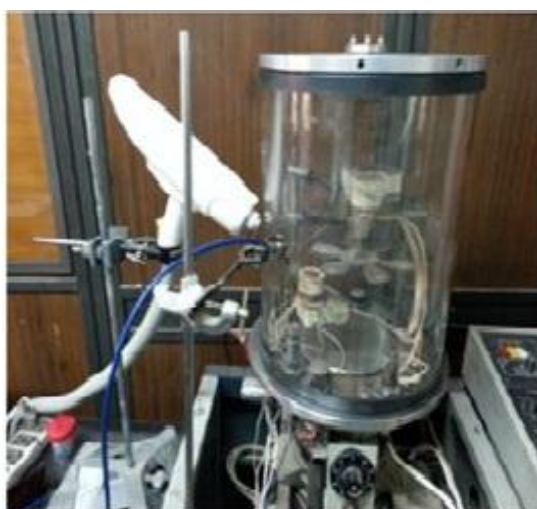
Fig. 1. PLD chamber using Nd:YAG laser.
