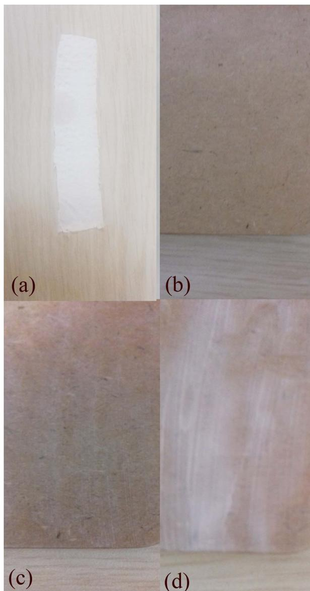
Fig. 8. UL 94 test of the (a) CA-Mg(OH)<sub>2</sub> nanocomposite (b) pristine wood (c) wood-Mg(OH)<sub>2</sub> nanocomposite (d) wood-Al(OH)<sub>3</sub> nanocomposite
