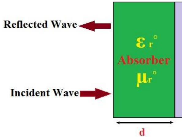
Fig. 7. Single layer absorber
