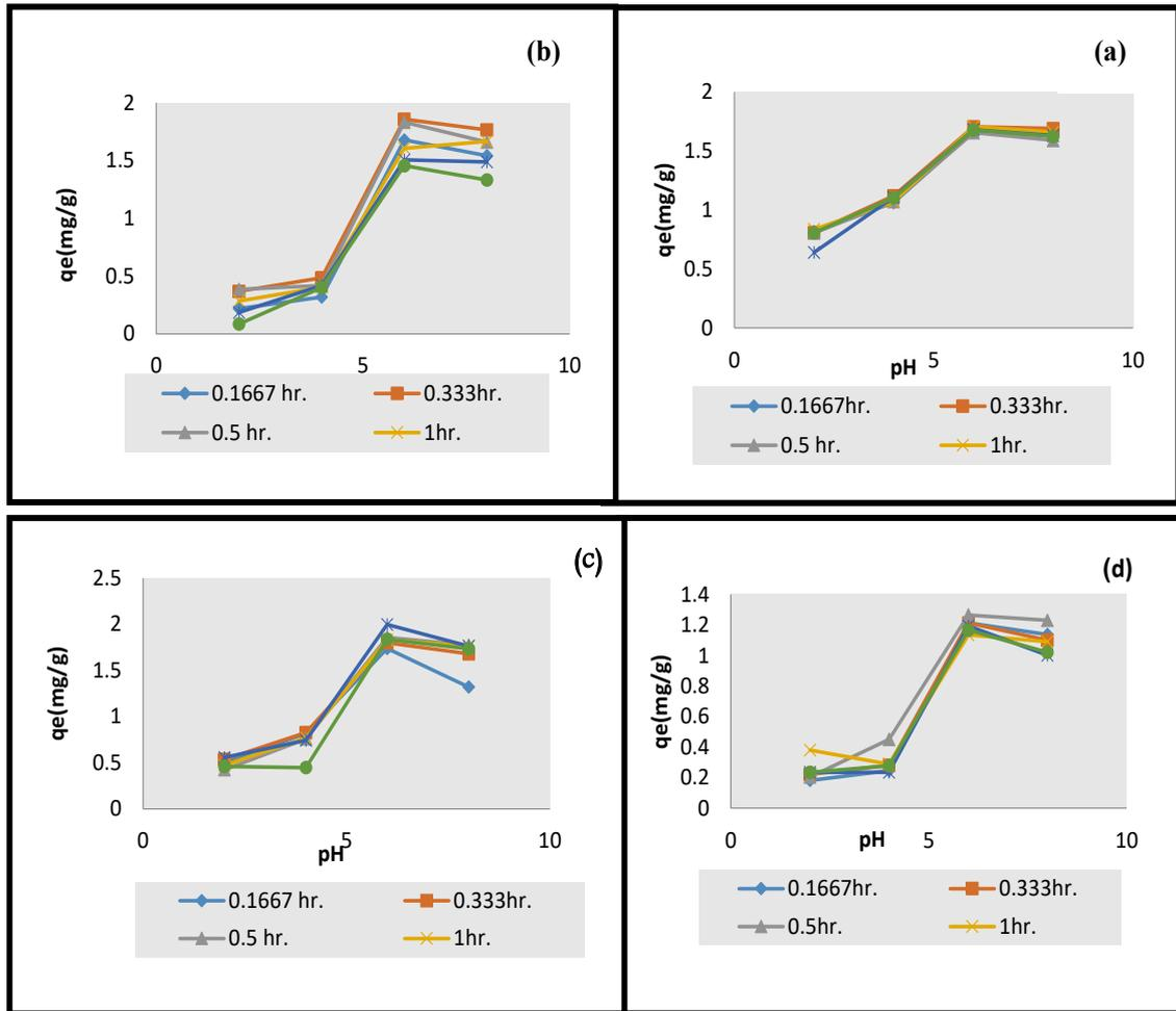
Fig. 6. Effect of pH on metals removal by (NM semi IPNs) : (a)  $Pb^{+2}$  (b)  $Cd^{+2}$  (c)  $Cu^{+2}$  (d)  $Co^{+2}$
