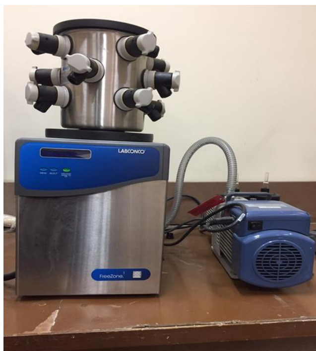
Fig. 1. Lyophilization instrument, LABCONCO Company (USA). ábra Liofilizáló készülék LABCONCO Company (USA)
