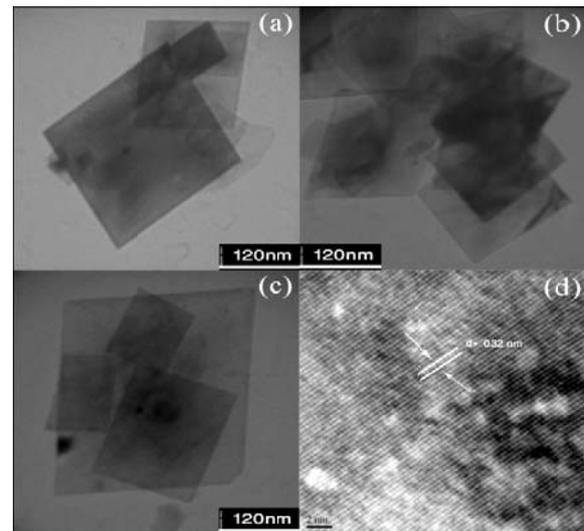
**Fig. 3.** TEM (a, b, c) and HRTEM (d) images of as-synthesized  $\text{LaVO}_4: \text{Tm}^{3+}$  nanosheets.
