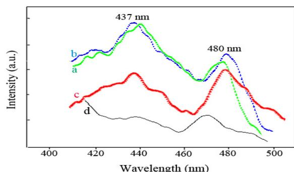
**Fig. 5.** The emission spectra of  $La_{1-x}VO_4:Tm_x^{3+}$ : (a)  $x = 0.005$ , (b)  $x = 0.01$ , (c)  $x = 0.02$ , (d)  $x = 0.04$ .
