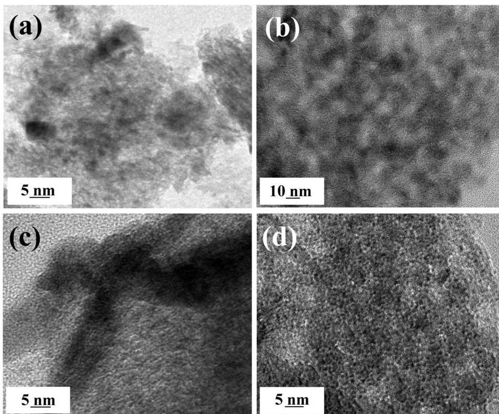
Fig. 4. HRTEM micrographs of (a) Ir-100Al, (b) Ir-97Al3Si, (c) Ir-50Al50Si, and (d) Ir-3Al97Si.
