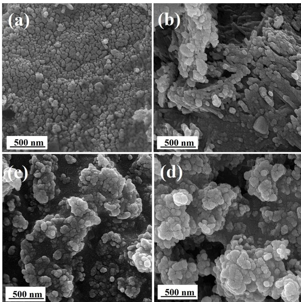
Fig. 5. FESEM micrographs of (a) Ir-100Al, (b) Ir-97Al3Si, (c) Ir-50Al50Si, and (d) Ir-3Al97Si.
